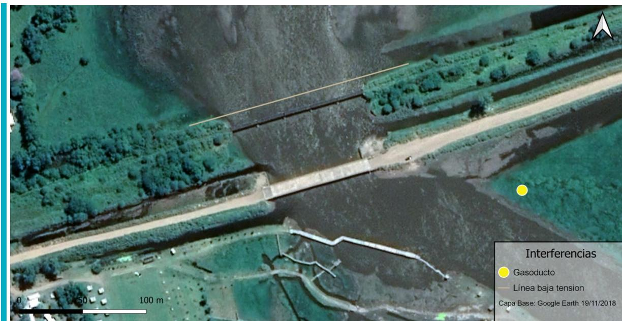
**Figura 26:** Interferencias inmediatamente asociadas al puente (gasoducto y línea de baja tensión).Fte Elaboracion DEA-DPH 2020
