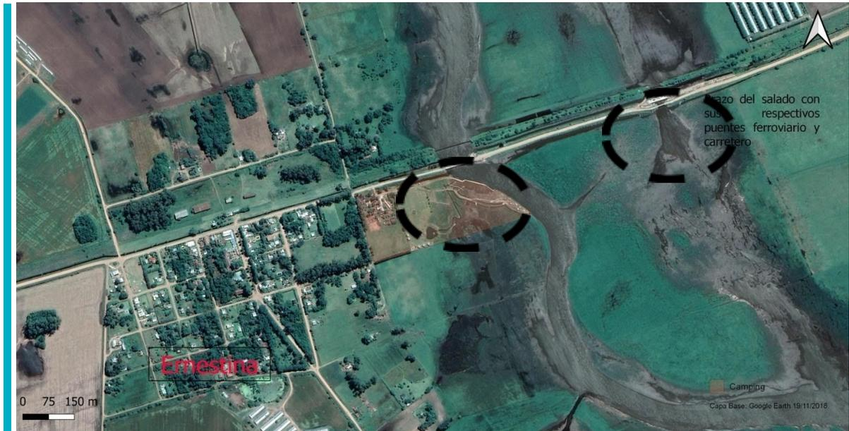
**Figura 22:** Área de Influencia Directa (AID). Se puede apreciar la localidad de Ernestina y el camping marcado con naranja. En el centro de la figura, enmarcado en un círculo se encuentran los puentes ferroviario (obra) y carretero que cruzan el cauce principal del río Salado, y a su derecha (Noreste de la obra) los respectivos par de puentes que cruzan un curso secundario del río. Fuente: Elaboración propia, Año 2020.
